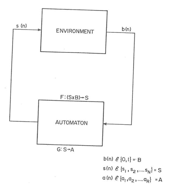
FIG. I: THE AUTOMATON-ENVIRONMENT INTERACTION
